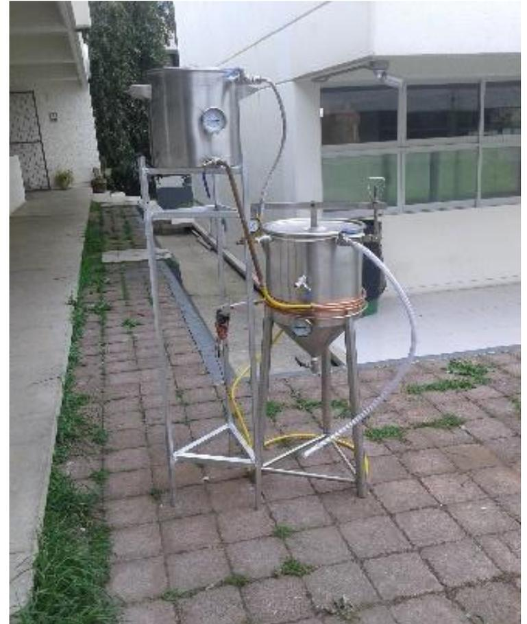
Con el Arduino uno se generara la programación para monitorear la presión, pH, temperatura y humedad en el biorreactor.
